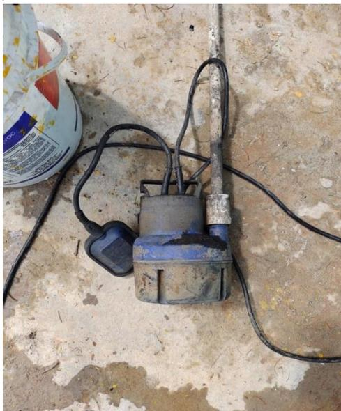
Imagen 1. Bomba sumergible dañada.
